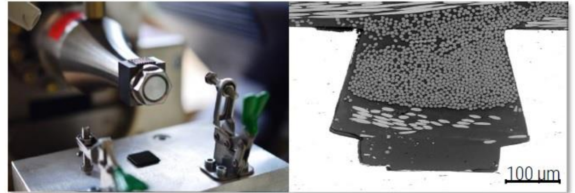
Anlagentechnik zum ultraschallunterstützten Fügen (links), Erhöhung der Verbundfestigkeit durch Mikrostrukturierung (rechts)
