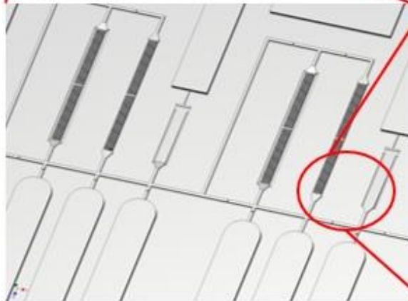
Prägewerkzeug mit mehreren Einzelsensoren
