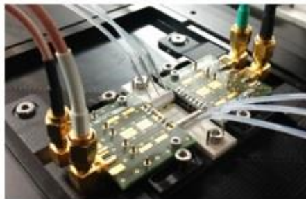
Akustofluidiksetup für die Mikroskopie
